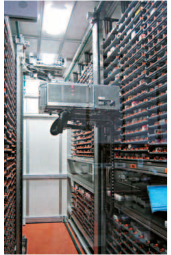
Der Kommissionierautomat kann 13 000 Packungen einlagern und verwalten.
